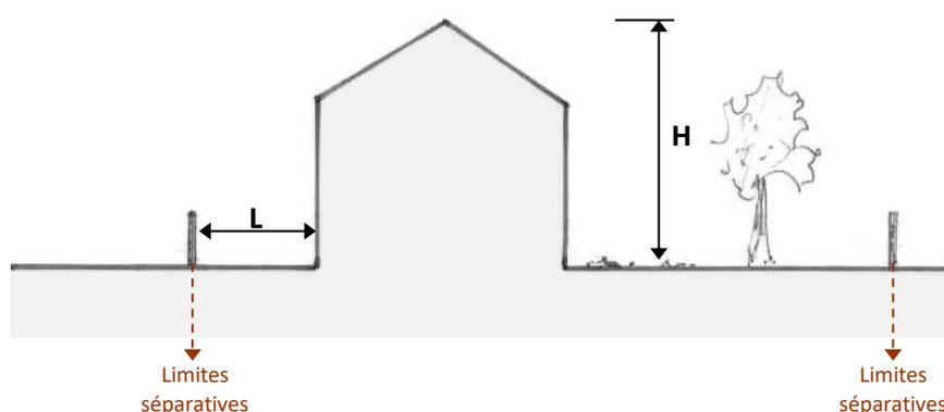
**H** = la hauteur maximale de la construction
