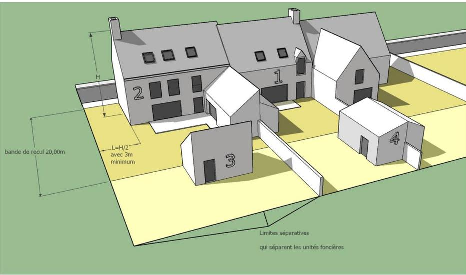
**Implantations avec marge de retrait :** Lorsque l'implantation ne se réalise pas sur les limites séparatives, une marge d'isolement est imposée ; celle-ci est définie suivant le rapport  $L = H/2$  illustré ci-après.
